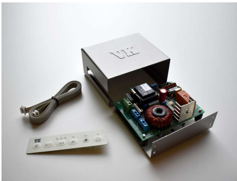
Printhus, printstyringsplade, fladkabel og betjeningspanel
